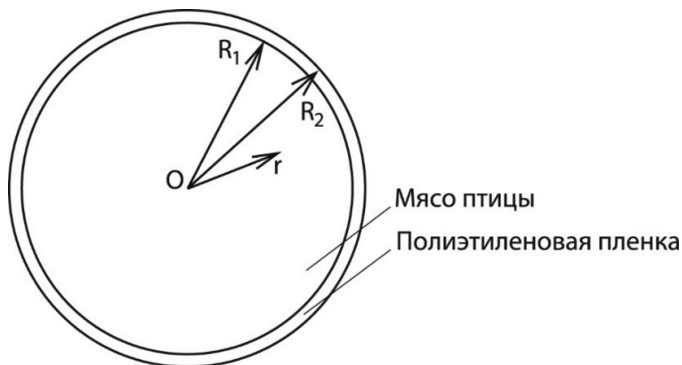
Рис. 4. Схема к расчету процесса охлаждения изолированно-го полиэтиленовой пленкой мяса птицы крупного размера.
