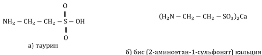
Рис. 1. Структурная формула таурина (а) и его производного бис (2-аминоэтан-1-сульфонат) кальция (б)
